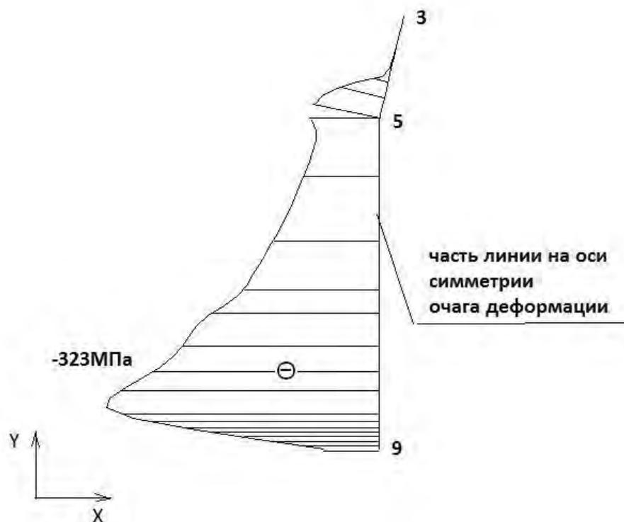
Рисунок 1.4 – Характер напряжений по оси ОХ на оси симметрии. Положение точек смотри на рисунке 1.3. Толщина полосы на выходе – 3мм
