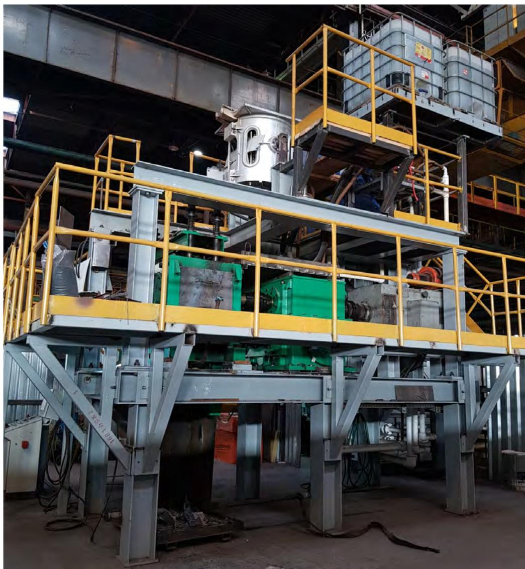
Рисунок 4.51 – Установка непрерывного литья и деформации ОАО «Уральский трубный завод»
