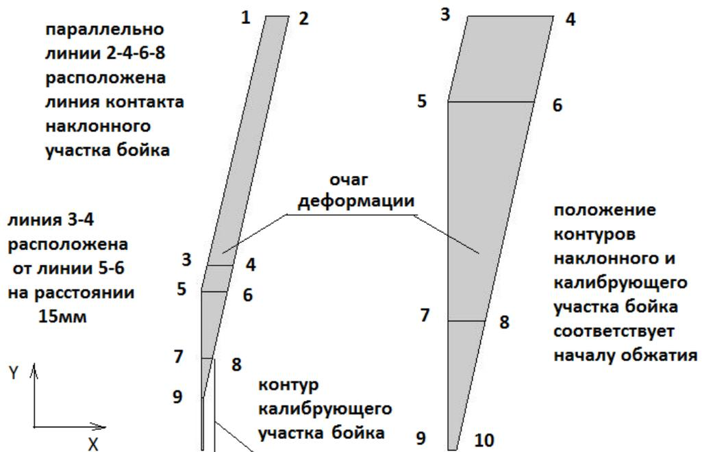
Рисунок 1.3 - Положение очага деформации, наклонного и калибрующего участка бойка перед началом рабочего хода
