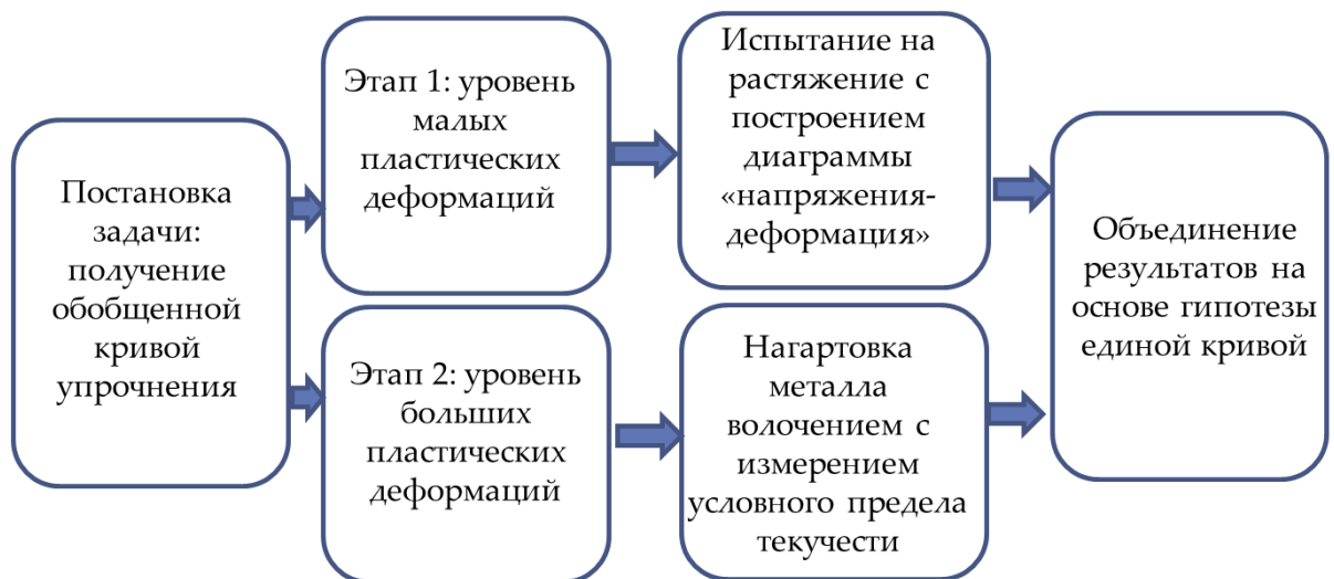
Рисунок 2.1 – Графическое отображение методики испытаний
