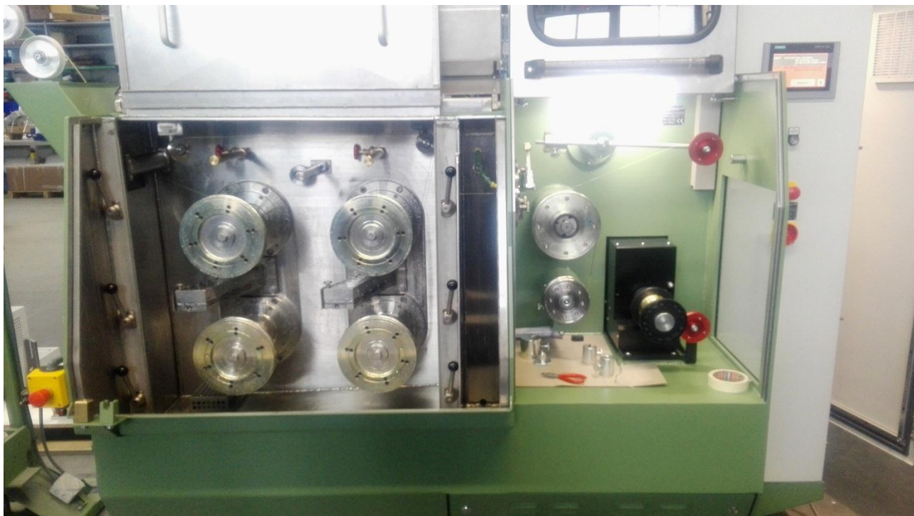
Рисунок 4.27 – 19-ти кр. волочильная машина Schmidt тип 180-15
