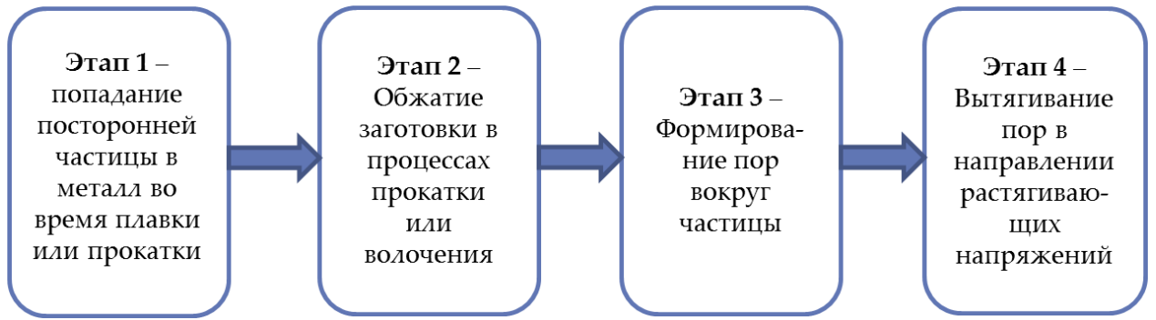
Рисунок 3.2 – Алгоритм образования раковины вокруг частицы включения
