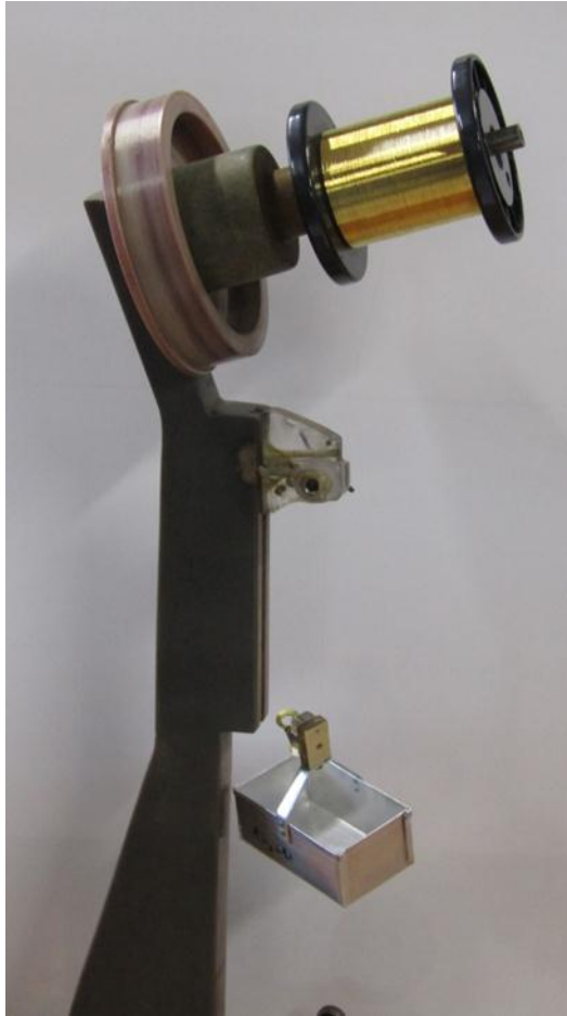
Рисунок 4.30 – Установка для проведения испытаний на разрыв для проволоки микронных размеров
