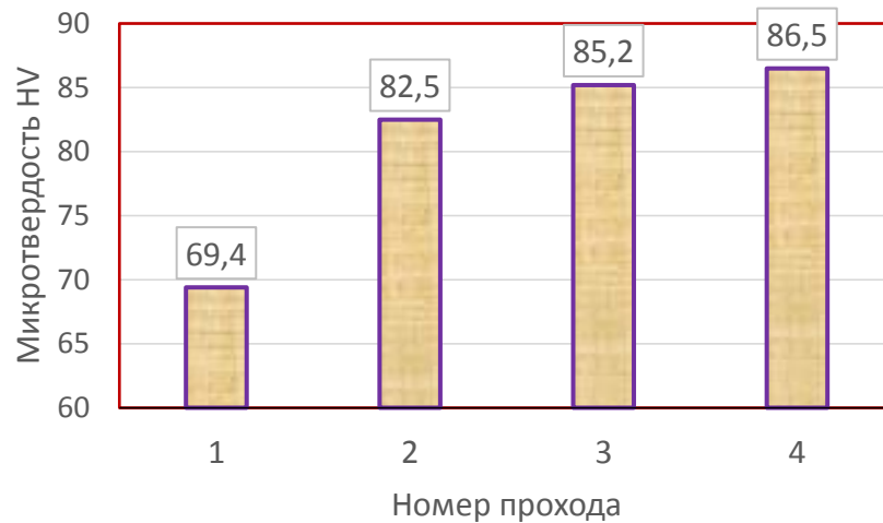
Рисунок 4.5 – Микротвердость поверхности серебряной проволоки по проходам скальпирования
