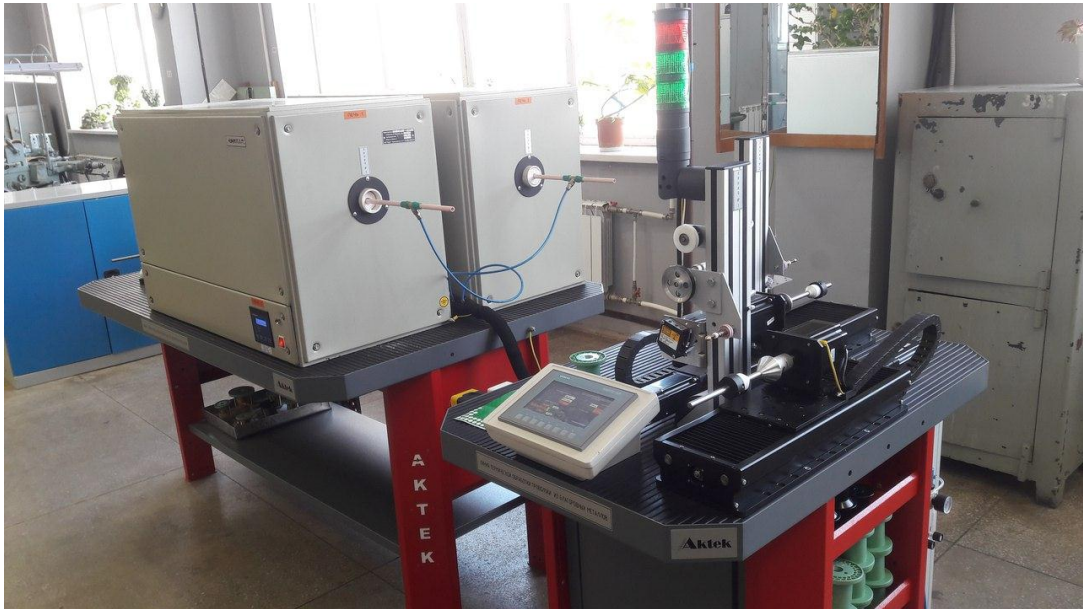
Рисунок 4.29 – Трубчатая печь фирмы АКТЕК для проходного отжига проволоки
