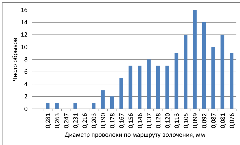
Рисунок 3.11 – диаграмма распределения частоты обрывов по маршруту волочения проволоки из платино-родиевых сплавов
