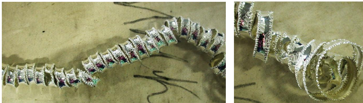
Рисунок 4.1 – Стружка, полученная в результате скальпирования проволоки Ср 99,99
