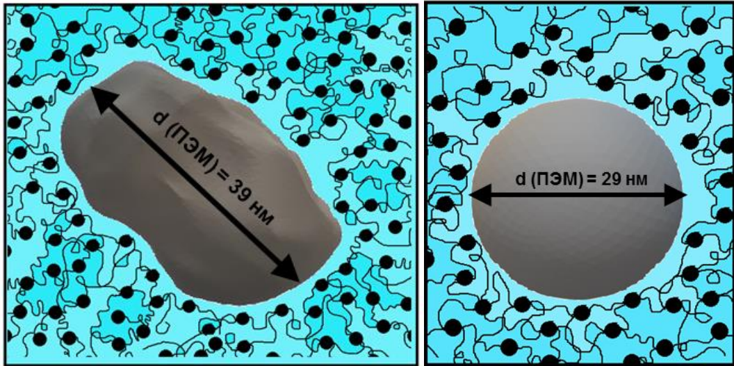
Рисунок 5.5 – Схематическое изображение масштабов полимерной сетки и наночастиц \text{TiO}_2 -P25 (слева) и \text{TiO}_2 -ЭВП (справа) в структуре композитного гидрогеля ПAA/ \text{TiO}_2
