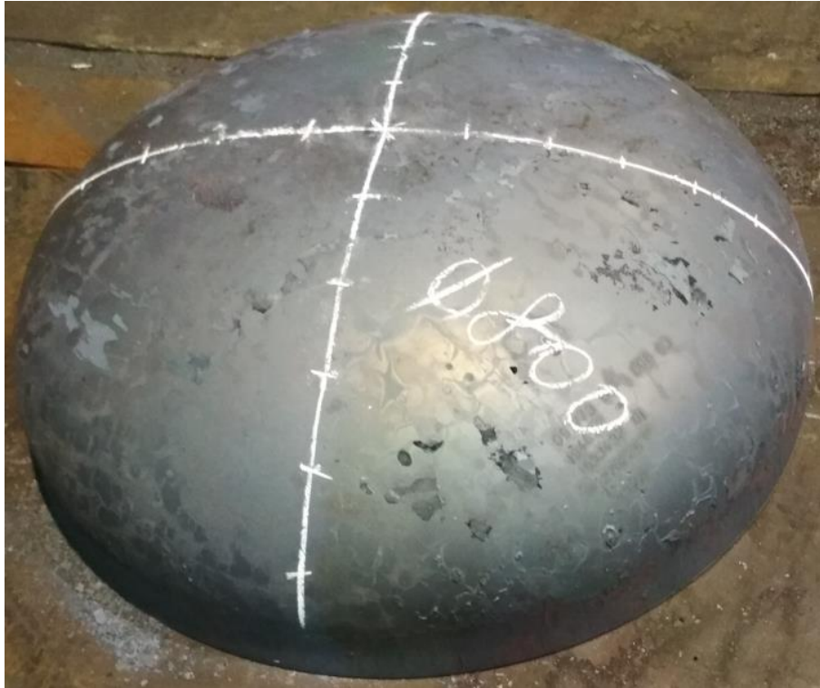
Рисунок 2.3 - Подготовка штампованного днища для измерения толщины
