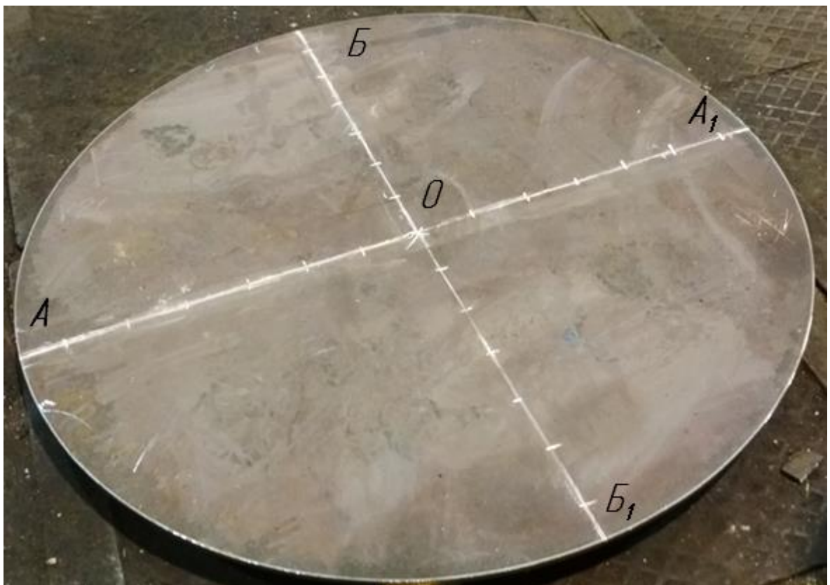
Рисунок 2.2 - Подготовка заготовки днища для измерения толщины
